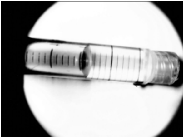
Figura 3. Coluna graduada em centímetros com tubo de Donaldson e água da torneira com pressão de 2 cm H 2 O sem ocorrer escape de líquido através do orifício.
