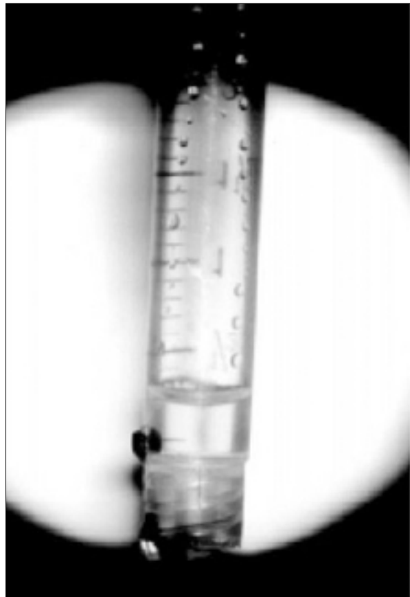
Figura 4. Coluna graduada com tubo de Donaldson e água com sabão com pressão de 0,6 cm H 2 O no momento da passagem do líquido através do orifício.
